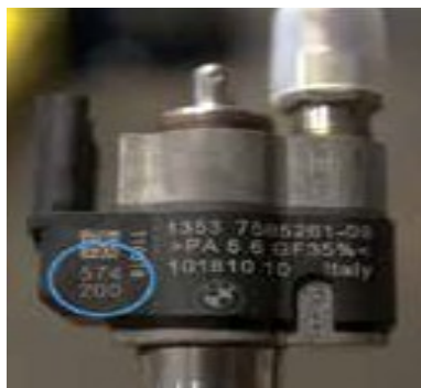
Przykładowe umiejscowienie nadrukowanych wartości kalibracyjnych na wtryskiwaczu.
